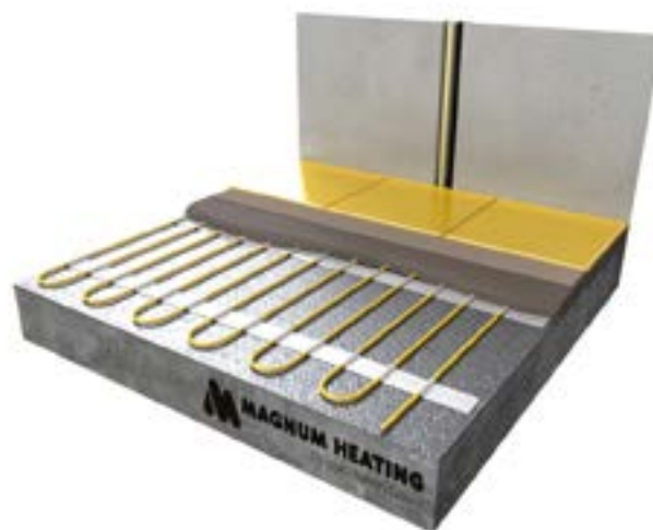
Instalare cu MAGNUM Isorol și bandă
