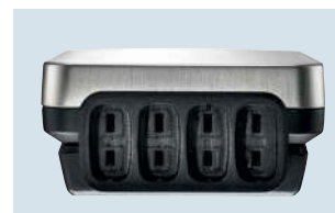
Conexiune la capătul inferior al carcasei pentru patru sonde cu termocuplu (Tip T, K și J)
