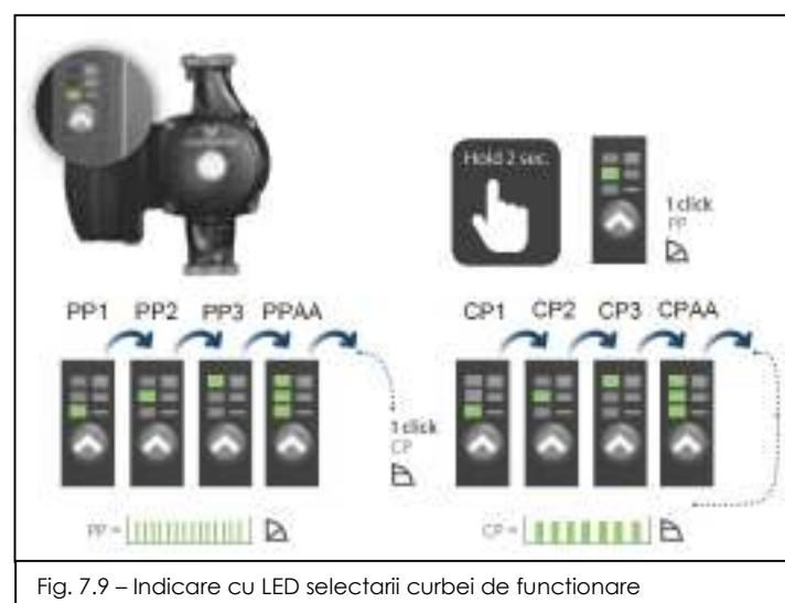
Fig. 7.9 – Indicare cu LED selectarii curbei de funcționare
