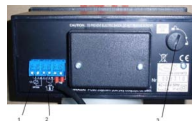
Fig. 3 Vedere din spate a regulatorului electronic
